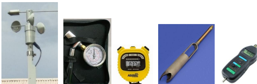
(a) anemometer (b) Pressure gauge (c) stopwatch (d) soil auger (e) Tachometer
